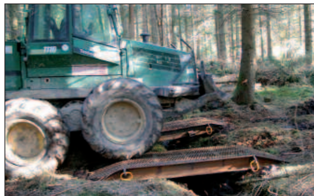
Tracteur sur un pont métallique
